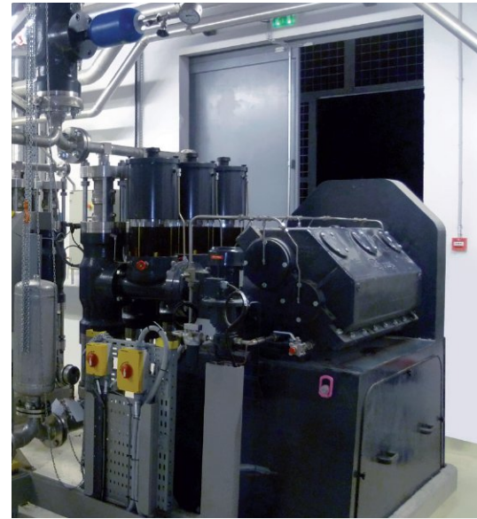
Подача в автоклавы с использованием трехцилиндровых двухшланговых мембранных насосов одностороннего действия MULTISAFE®.
