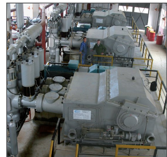
На глиноземном заводе в Китае каждый из 6 насосов FELUWA MULTISAFE® перекачивает до 95 м³/ч красного шлама в час под давлением 120 атм.
